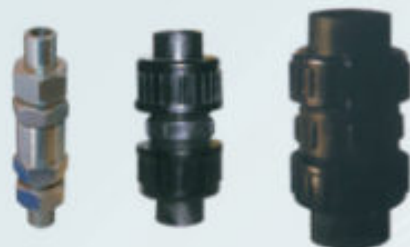
单向阀： 能阻止管路中的液体不形成倒流。 又名：截止阀。内置不锈钢弹簧。 常用材质：PVC、304、316、内衬四氟 常用口径：DN10 DN15 DN25 DN32 DN40
