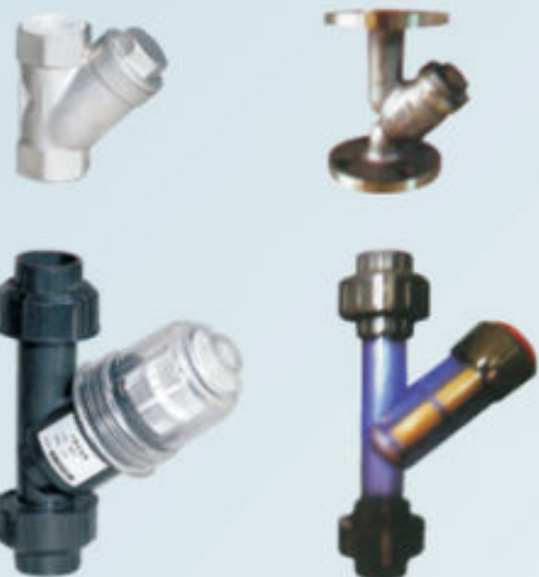
Y型过滤器： 能过滤介质中的杂质，对计量泵形成保护作用，一般安装在进口管路上并靠近计量泵。 常用材质：PVC、304、316、内衬四氟 常用口径：DN10 DN15 DN25 DN32 DN40
